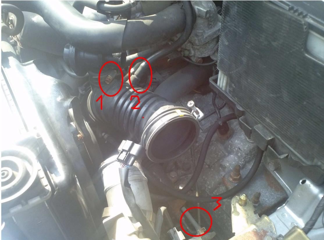
Hier wird jetzt die Schlauchschelle an der Unterseite des BOV gelöst(1)---dann der Nockenwellenentlüftungsschlauch(2)abgezogen und zuletzt der kleinere Schlauch der zum Solenoid/Ventil geht(3)abgezogen.Also nicht an der hier markierten Position am solenoid selbst(3)sondern am Turborohr oben!!Der Schlauch selber ist hier leider nicht zu sehen da er zu weit unten liegt!
