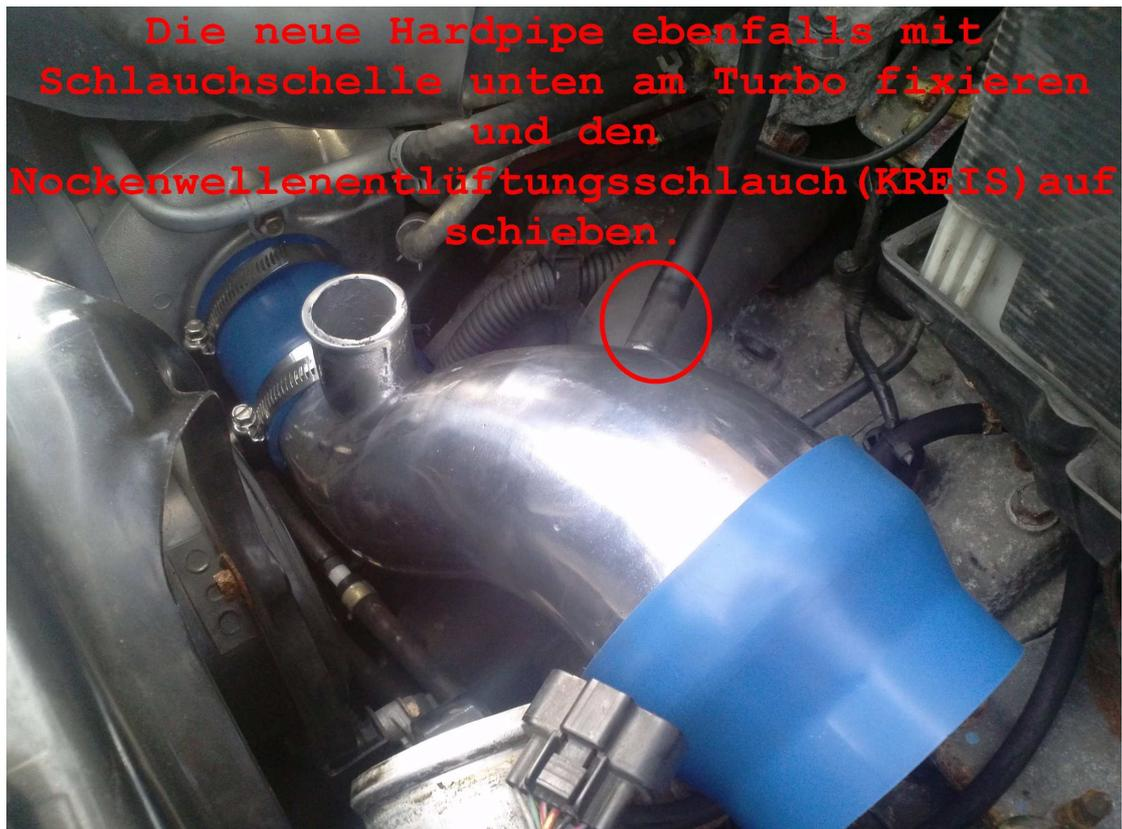
Erstmal dem Fototext folgen,danach den kleinen Schlauch vom Solenoid kommend,an der Hinterseite der Hardpipe aufstecken,die Positionen der Schläuche an der Hardpipe sind im nächsten Bild noch mal gut zu erkennen,da gibt's eigentlich nichts falsch zu machen!!Dann noch das blaue gummiverbindungsstück von der Pipe zur Luftmassenmesseradapterplatte ca.20mm auf die Pipe aufschieben und mit der mitgelieferten Schlauchschelle direkt befestigen(hier im bild noch ohne schelle)
