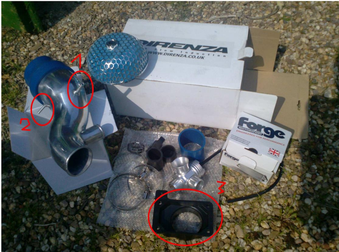
Hier ist der bislang versteckte Solenoidanschluss schön zu erkennen(2) sowie noch mal der Anschluss der Nockenwellenentlüftung(1)
