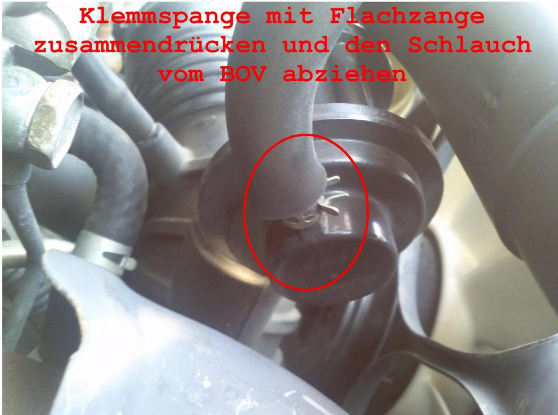
Hier das BOV von links oben gesehen! Nachdem dieser Schlauch abgezogen wurde, kann das BOV entfernt und beiseite gelegt werden.
