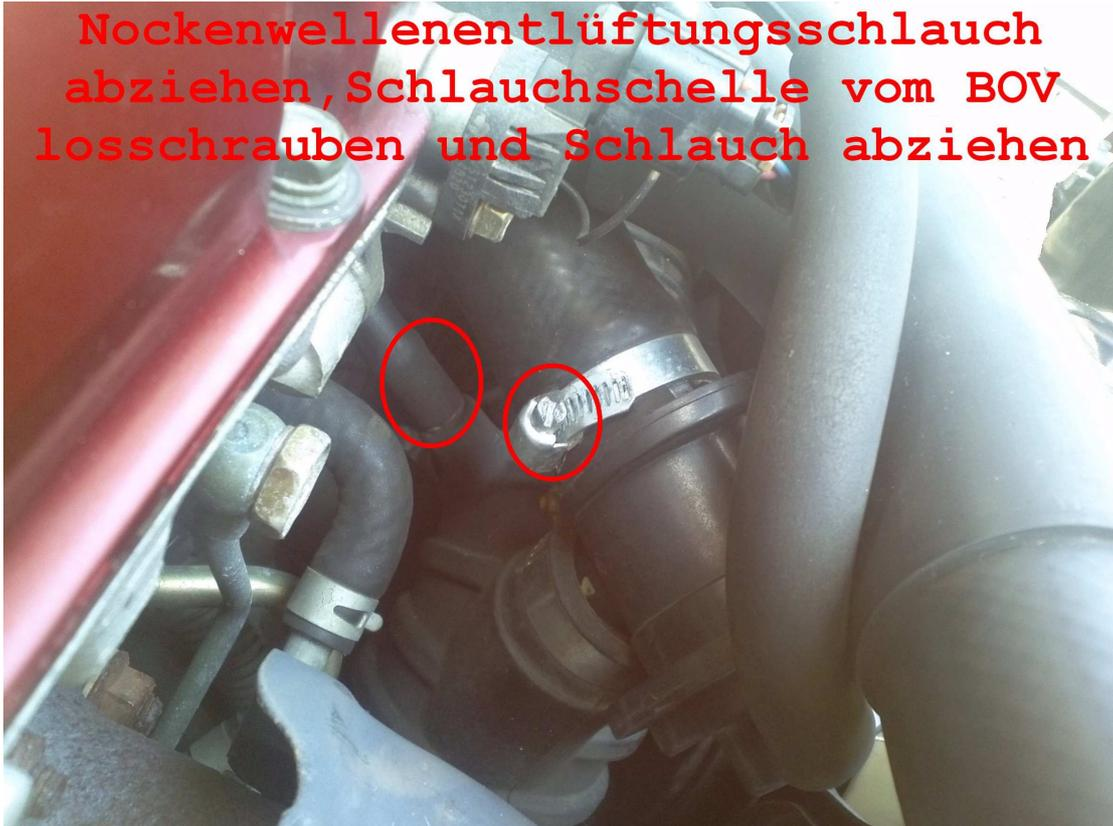
Hier noch mal der Nockenwellenentlüftungsschlauch aus einer anderen Perspektive, ansonsten wie auf dem Foto beschrieben fortfahren!
